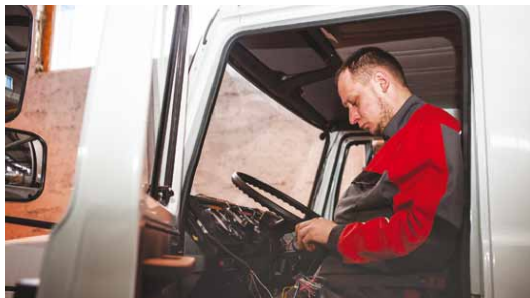
Монтаж бортового оборудования ГЛОНАСС на автомобиле ГАЗ 3308
