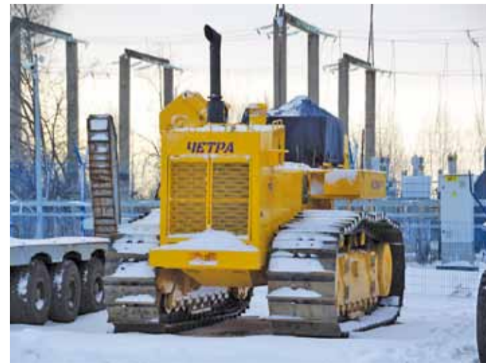
Новый трубоукладчик для работ на трассе
