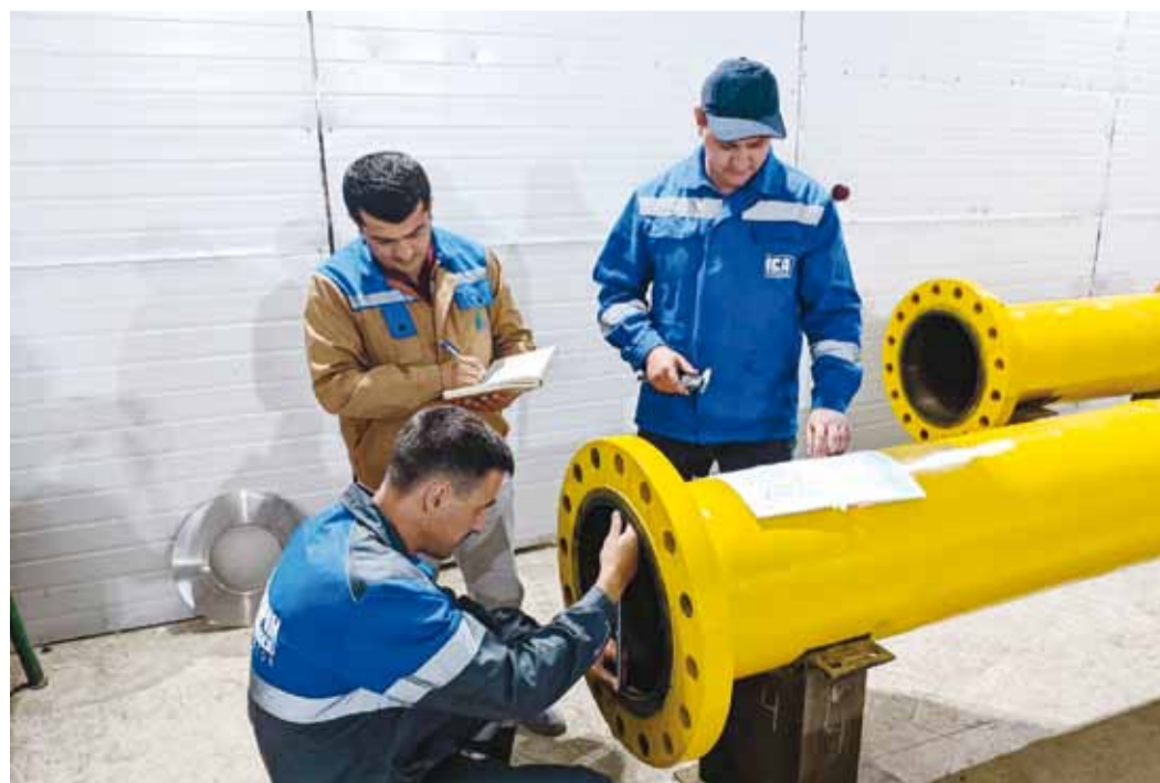
Проверка измерительных трубопроводов и камер усреднения на соответствие ГОСТ, Узбекистан
