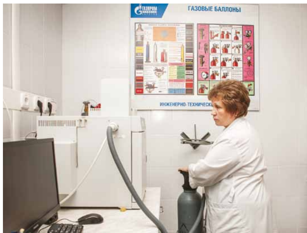
Инженер-химик 2-й категории Вера Васенкова определяет компонентный состав природного газа методом газовой хроматографии с оценкой неопределенности
