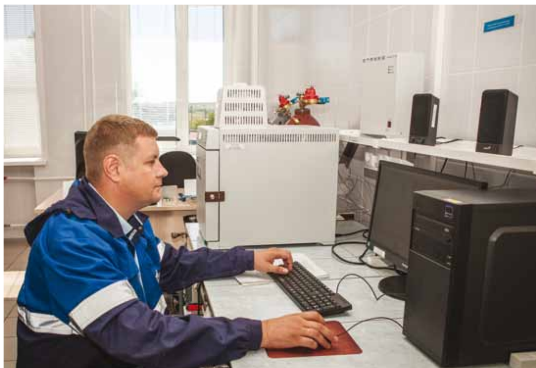
Осуществляется аттестация утвержденного типа стандартных образцов состава магистрального природного газа ГСО-ПГМ-6 1-го разряда в баллонах под давлением. За работой инженер-химик 1-й категории Андрей Юнкеров
