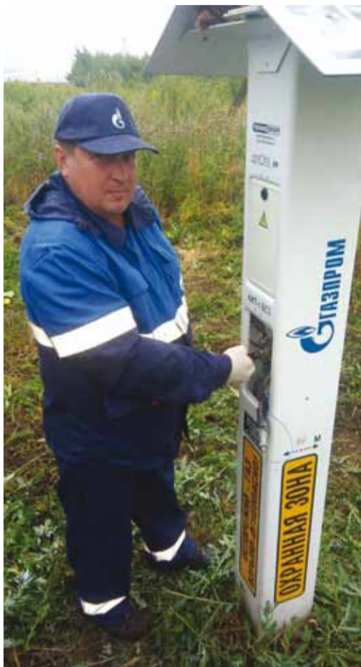
Проводится замер поляризационного потенциала
