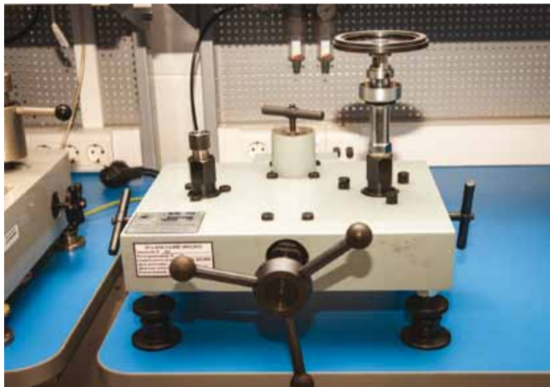
Грузопоршневой манометр используется для поверки средств измерения давления
