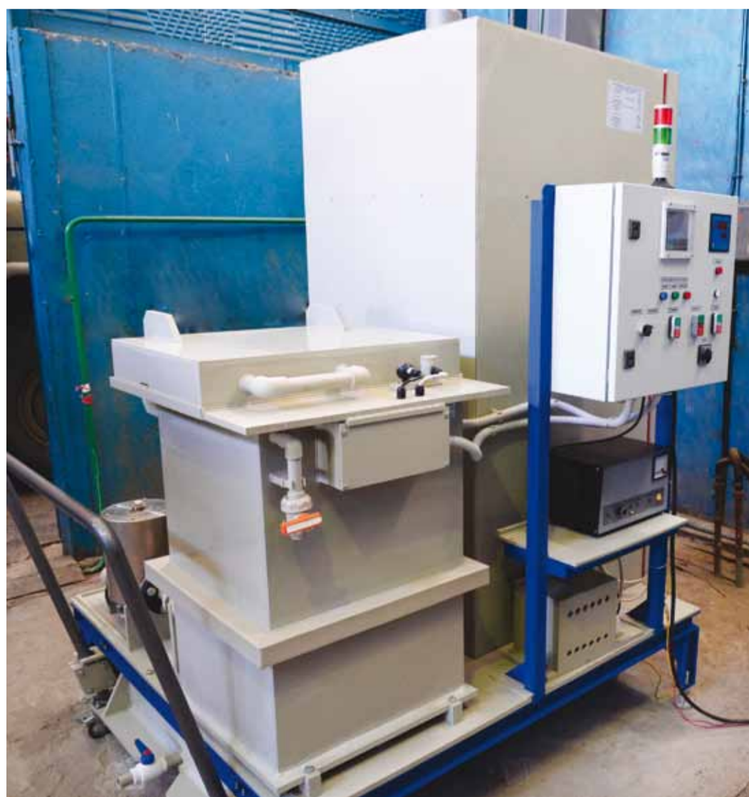
Установка для сверхвысокочастотной обработки (очистки) горелочных устройств
