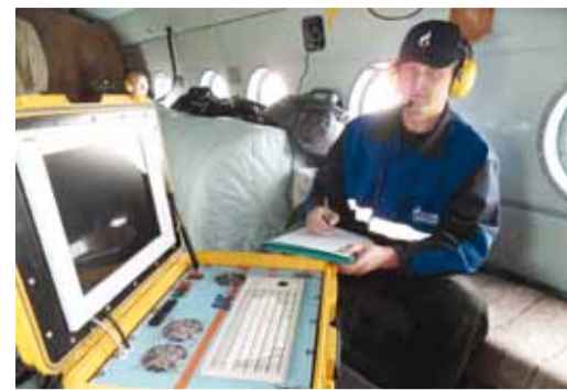
Воздушное обследование трассы МГ с применением ДЛС-Пергам ведет В.Кротов
