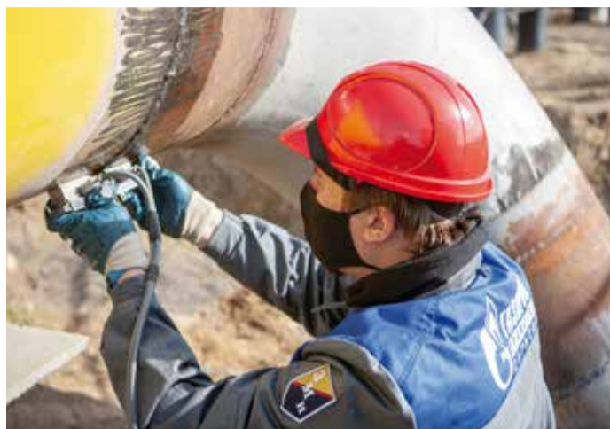
Работники полевой измерительной лаборатории ИТЦ проводят ультразвуковой контроль сварного соединения методом ультразвуковой дефектоскопии
