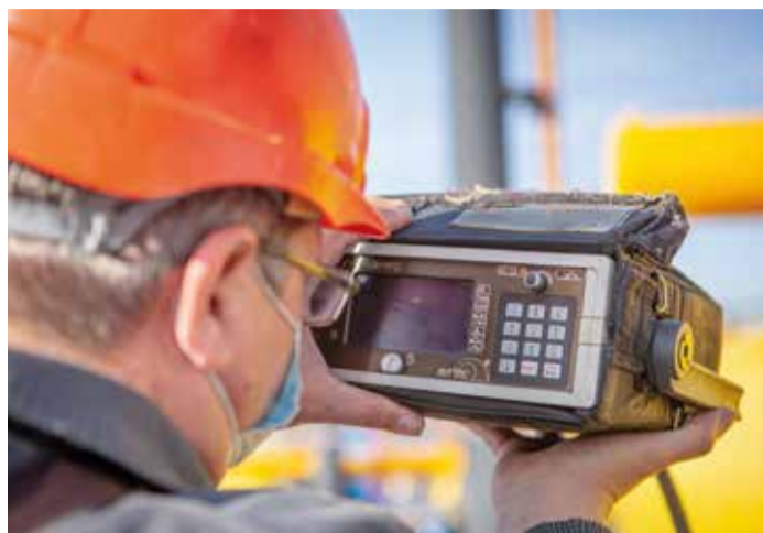
Работники полевой измерительной лаборатории ИТЦ проводят ультразвуковой контроль сварного соединения методом ультразвуковой дефектоскопии
