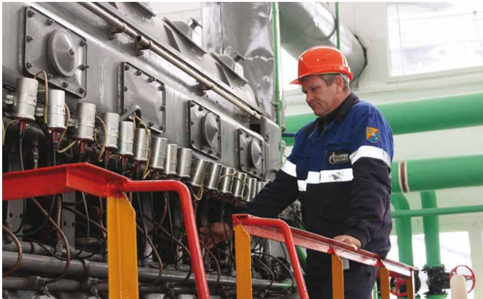
Сергей Логвинов производит замену свечей зажигания ДВС
