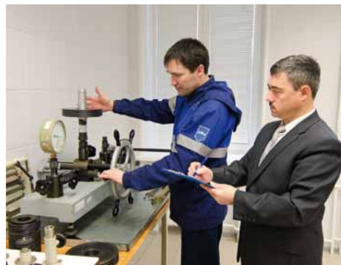
Лаборатория метрологии, стандартизации и учета расхода газа: Антон Антонов и Сергей Голубь проводят проверку манометра
