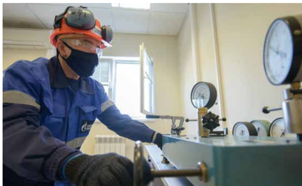
Калибровка манометра – дело ответственное, требующее внимательности
