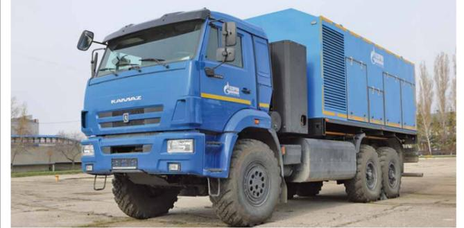
Азотная КС на базе УМТСuK
