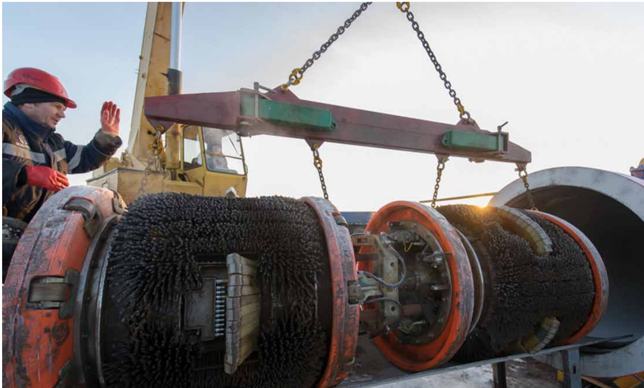
Тестовые пропуски дефектоскопа УМДП-1200 были проведены специалистами Екатеринбургского и Балашовского ЛПУМГ, ИТЦ, а также АО «Газпром оргэнергогаз»
