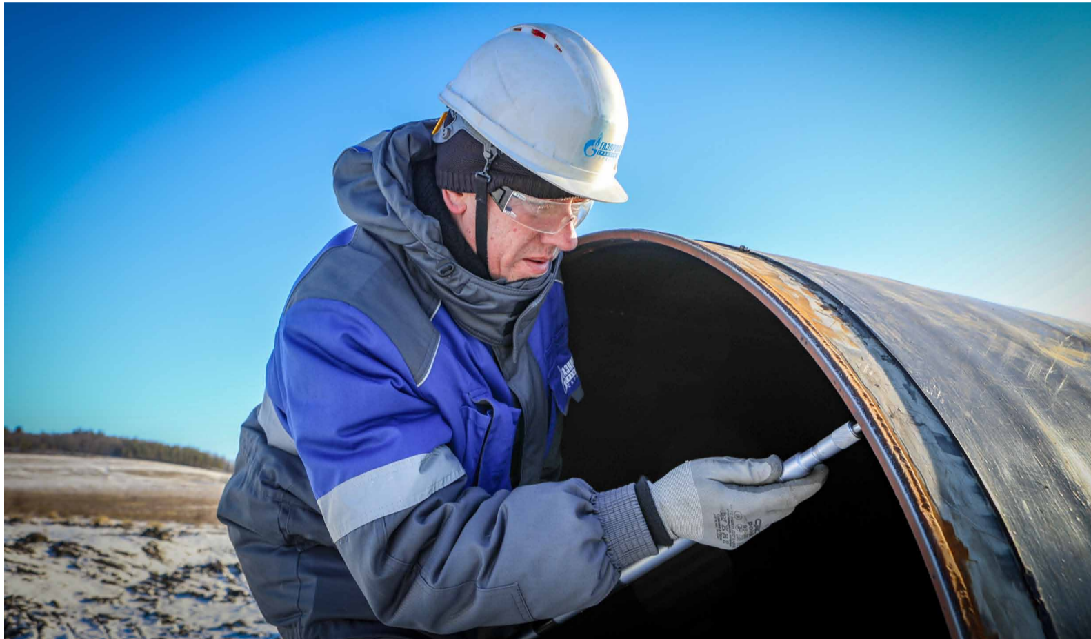
Ведущий инженер лаборатории технической диагностики ИТЦ Денис Петров проводит контроль овальности торца трубы
