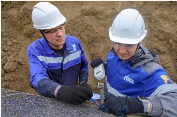
Измерение адгезионной прочности защитного покрытия к телу трубы
