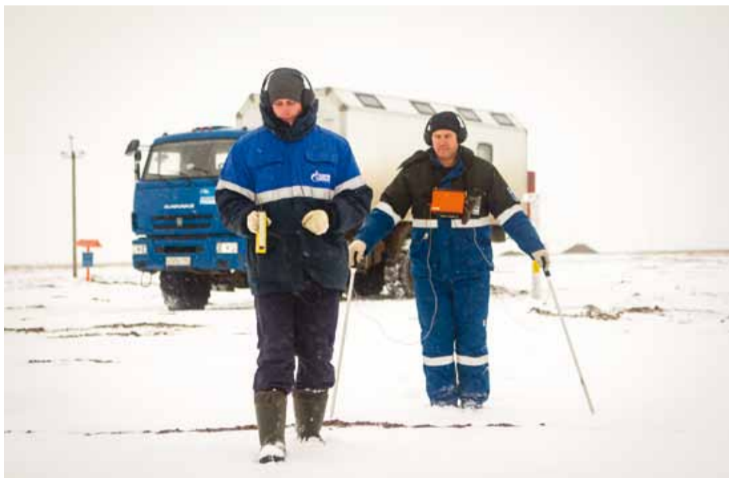
Инженер лаборатории ЭХЗ Алексей Предтеченский и инженер 2-й категории лаборатории ЭХЗ Алексей Зинин проводят комплексное периодическое коррозионное обследование МГ САЦ-2 Александровогоайского ЛПУМГ
