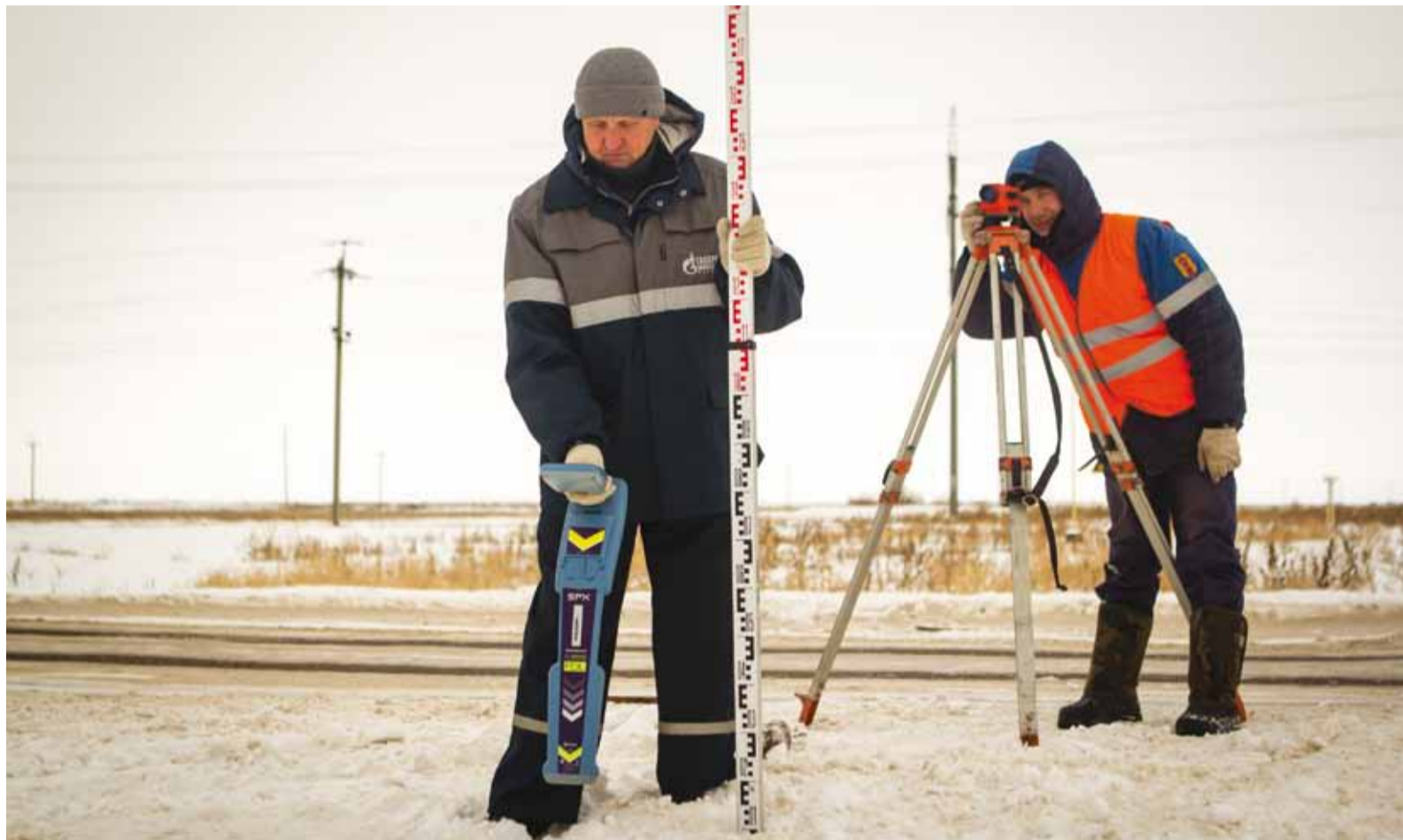
Ведущий инженер лаборатории технической диагностики Владимир Кротов и руководитель группы диагностики технического состояния ЛЧ МГ лаборатории технической диагностики Евгений Бондаренков ведут геодезическую съемку при диагностике перехода магистрального газопровода САЦ-3 через автомобильную дорогу
