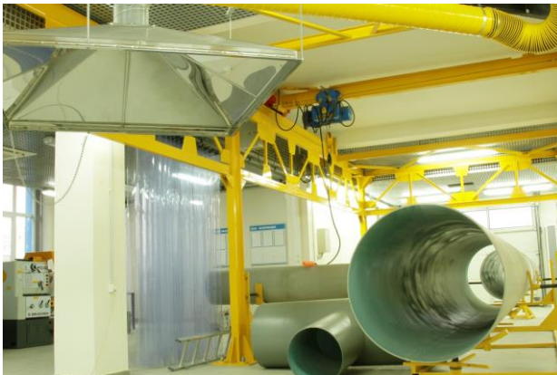
Полномасштабный тренажер по отработке навыков производства монтажных работ на МГ
