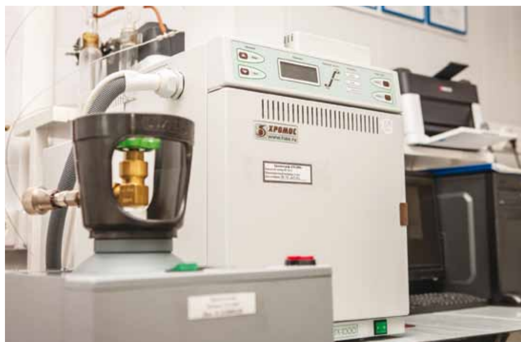
Рабочий эталон 1 разряда единицы молярной доли компонентов природного газа на базе хроматографического комплекса «Хромос GX-1000»
