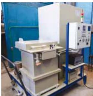
Обществом получен патент на изобретение способа ультразвуковой обработки горелочных устройств стационарных газоперекачивающих агрегатов и установки «Резонанс», при помощи которой восстанавливаются газодинамические и экологические характеристики агрегатов компрессорных станций.
