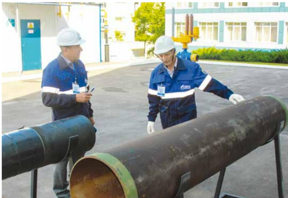
Определяется качество изоляционного покрытия
